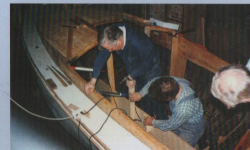
Abb. 6: Beim Einpassen der Plichtbänke
